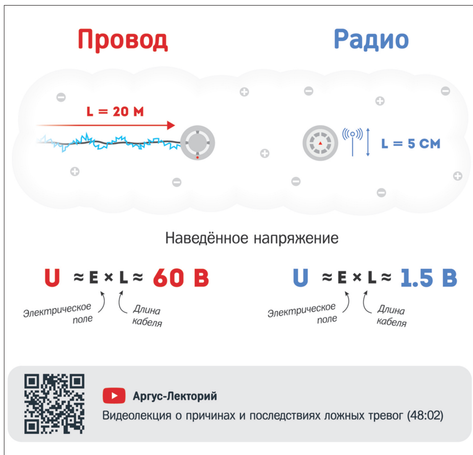
Рис. 1. Беспроводные СПС как один из вариантов повышения устойчивости к воздействиям электромагнитных помех на линиях связи
