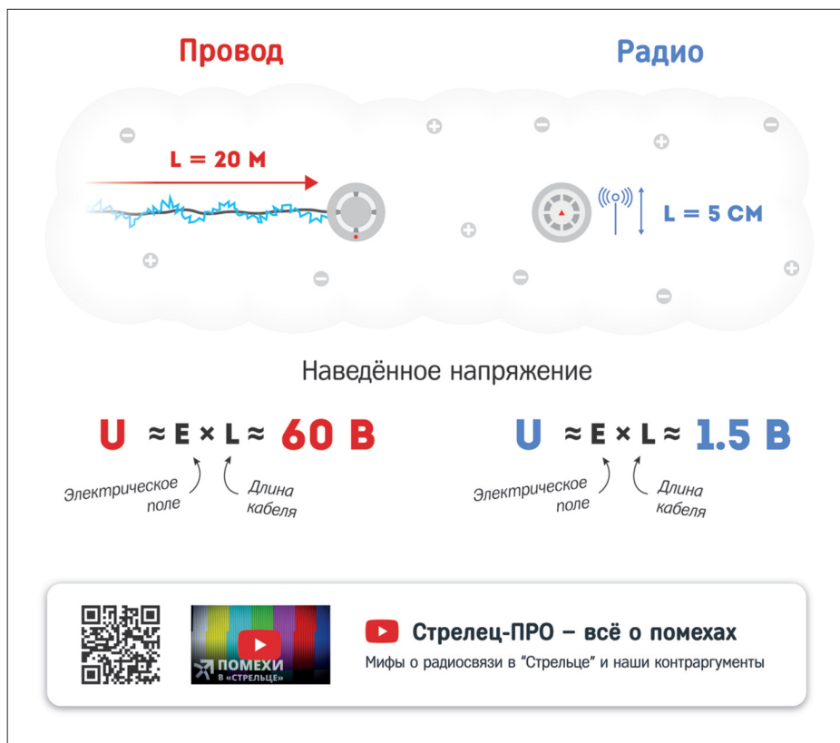
Рис. 2. "Стрелец" более устойчив к электромагнитным наводкам, чем проводные системы
